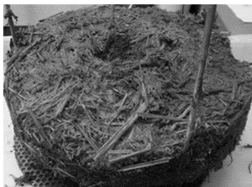
Куриный помет с соломенной подстилкой после переработки в лабораторной биогазовой установке
